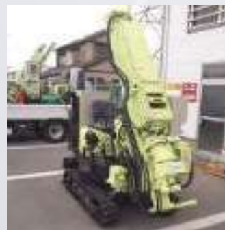
写真はSRS試験機 通称(オートマチックラムサウンディング)
